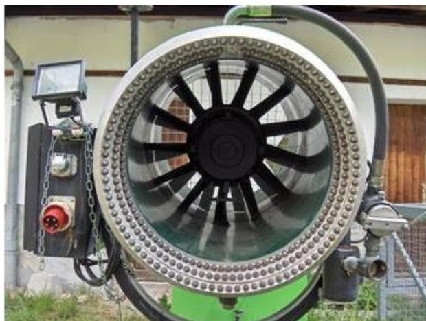
Через другую группу форсунок выбрасывается смесь воды и сжатого воздуха, которая формирует центры кристаллизации в виде мельчайших льдинок.
