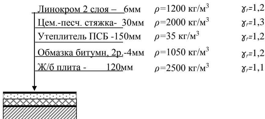
Рис.2. Конструкция покрытия
